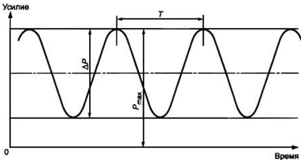
Рисунок Г.1 - Обозначения параметров повторяющейся нагрузки
